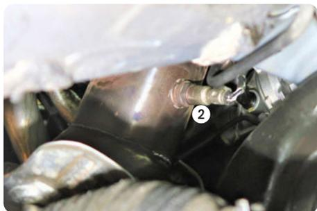
3. Flexrohr zwischen Downpipe und Abgasanlage lösen und ausbauen.
