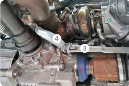
3. Flanschverbindungen zwischen Downpipe und Abgasanlage trennen.
